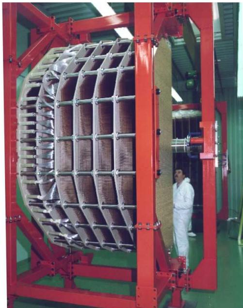
**Figura 1.10:** Immagine del calorimetro elettromagnetico a kripton liquido utilizzato nell'esperimento NA48 [14].
